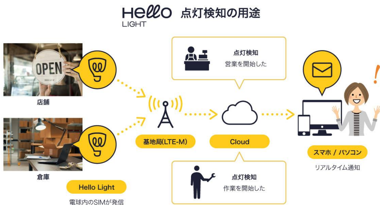
「Hello Light」の点灯検知の仕組みについて
